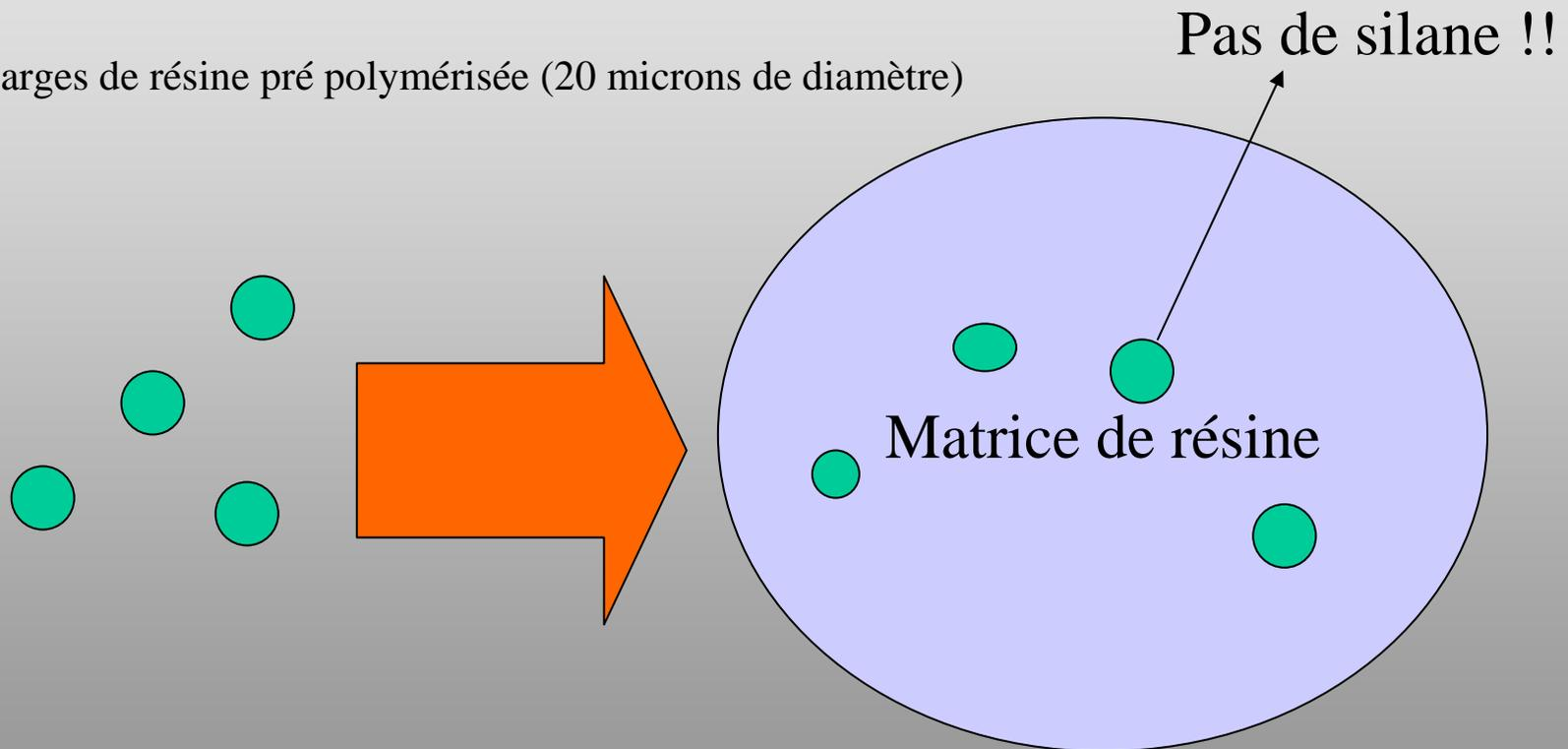
Charge résine + Matrice résine = composite homogène
